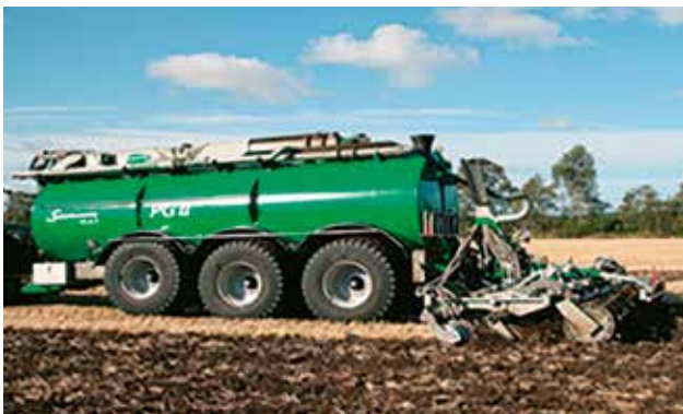
그림 6.9 흑색토 주입. 트레일 호스 적용 대비 약 85%의 N-배출량 감소. 사진 Samson Agro.
