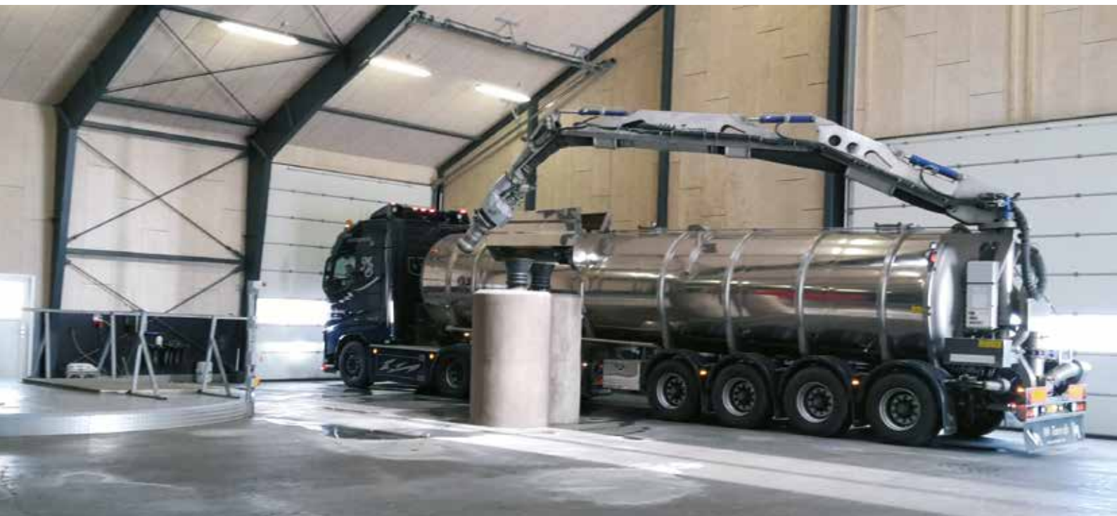
그림 5.9 분뇨 운송을 위해 특수 설계된 트럭. 사진 덴마크 식품 바이오 클러스터(Food & Bio Cluster)
