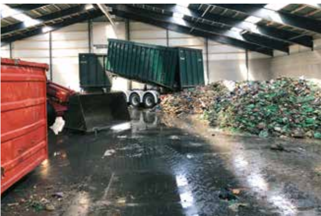
그림 4.7 이 시설은 모든 유형(가정, 상업 및 산업)에서 유기 폐기물(음식물 쓰레기) 자원을 분리하여 처리함으로써 순환 경제를 지원한다. 이러한 강력하고, 효율적이며 신뢰할 만한 자동화 공정은 음식물 쓰레기에서 발생하는 비닐봉지, 금속 캔, 플라스틱 병과 기타 포장과 같은 무기질 불순물의 제거를 보장하여, 순도가 높은 바이오펄프를 생산한다. 사진 Gemidan.
