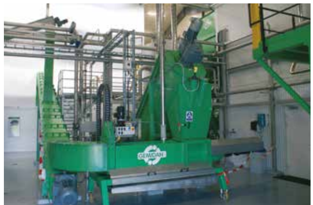
그림 4.7 이 시설은 모든 유형(가정, 상업 및 산업)에서 유기 폐기물(음식물 쓰레기) 자원을 분리하여 처리함으로써 순환 경제를 지원한다. 이러한 강력하고, 효율적이며 신뢰할 만한 자동화 공정은 음식물 쓰레기에서 발생하는 비닐봉지, 금속 캔, 플라스틱 병과 기타 포장과 같은 무기질 불순물의 제거를 보장하여, 순도가 높은 바이오펄프를 생산한다. 사진 Gemidan.
