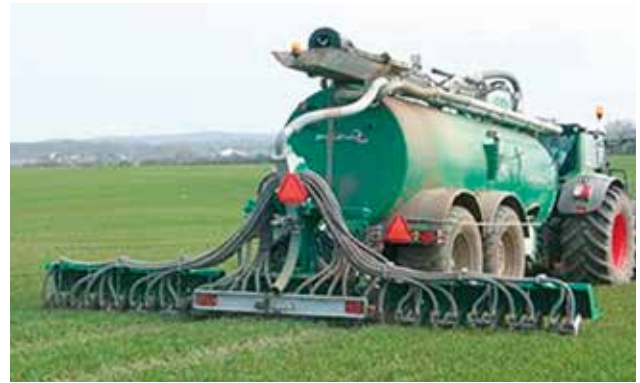
그림 6.8 풀에 주입. 트레일 호스 적용 대비 약 25%의 N-배출량 감소. 사진 Samson Agro.
